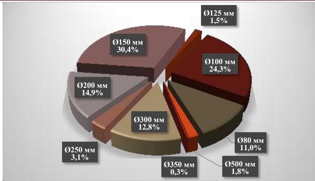
Рисунок 2.2.2.1 - Структура водопроводной сети г. Полярного (согласно отчетной документации ОАО «Водоканал») ЦСВ г. Гаджиево
